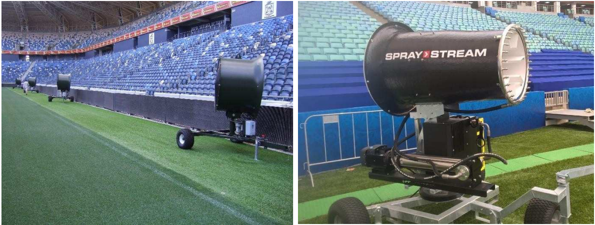
Slika 11 – Primeri prezračevalnih in hladilnih ventilatorjev, s katerimi se skrbi za zdravje trave.
