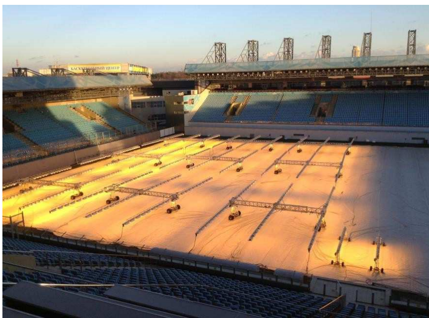
Slika 13 – Kombinacija razsvetljalnih naprav in prekrival za igrišče.
