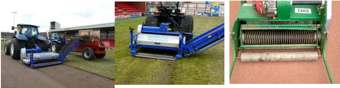
Slika 23 – Različne oblike odstranjevanja in zatiranja posušene trave. Z leve proti desni: popolna odstranitev površine, globoko brazdanje in navpična košnja. Vse tri oblike imajo zelo različne cilje.
