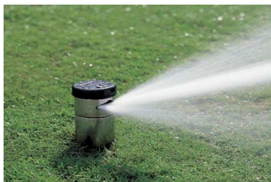
Slika 3 – Različne vrste zalivalnih sistemov, ki se uporabljajo za športne trate. Z leve proti desni: topovski, samovozni, statični in potopni zalivalnik. Za igrišča, ki gostijo UEFA tekme, so primerni le avtomatski potopni zalivalni sistemi.
