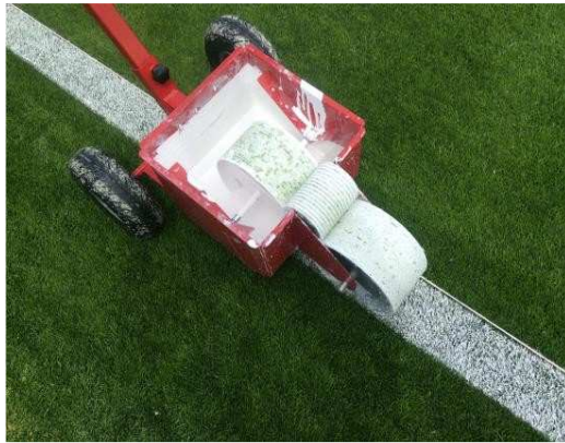
Slika 18 – Kolesno zarisovanje črte ob vrvici (levo) in zarisovanje črtkanih črt (desno).
